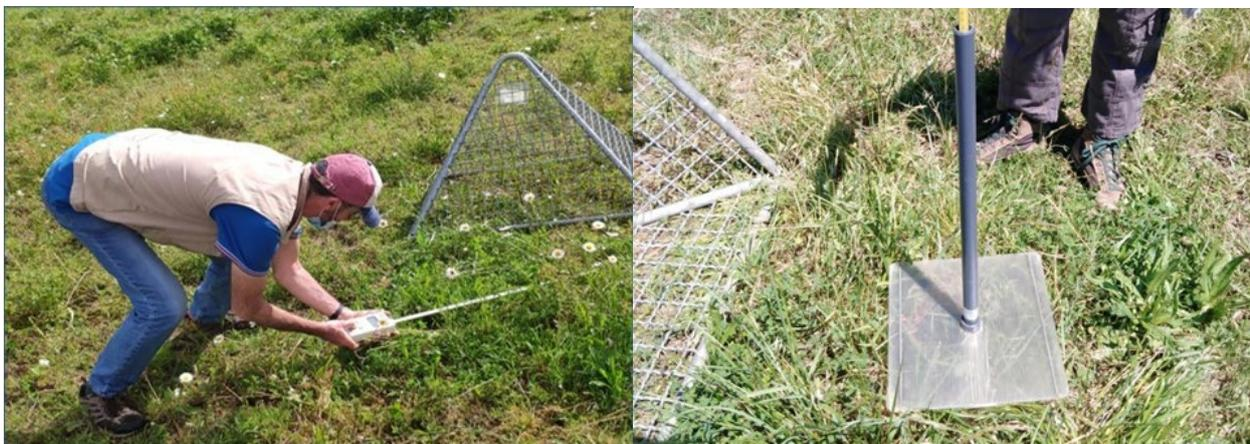
Fig.3 A sinistra misurazione della radiazione intercettata mediante ceptometro, a destra misurazione dell'altezza dell'erba tramite erbometro.
