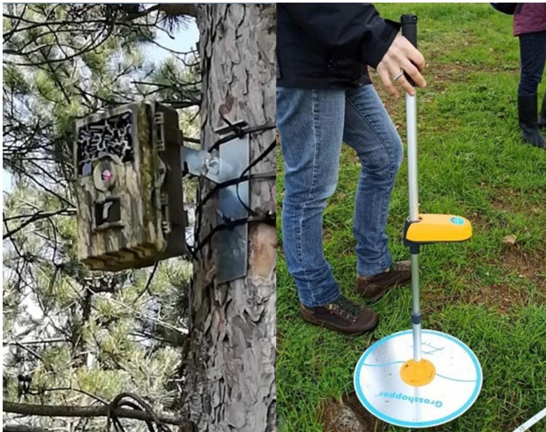
Fig.5 A sinistra fotocamera digitale RGB ad alta risoluzione, a destra l'erbometro elettronico Grasshopper®.
